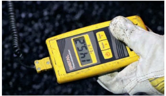
Die Einbautemperatur wurde stetig kontrolliert.
